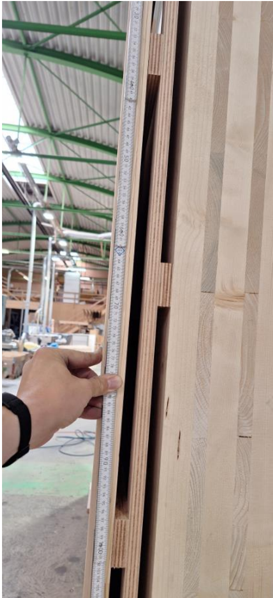
Abstände Unterkonstruktion Prüfkörper 1
