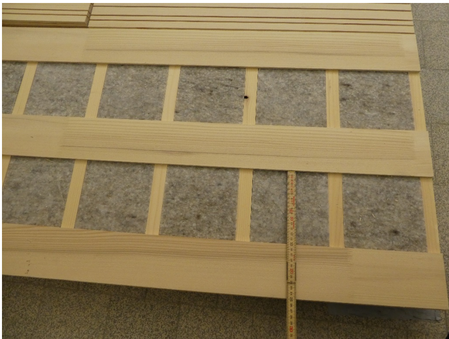
Abbildung 4: Innenaufbau von Prüfobjekt 1 mit integrierter Schafwolle
