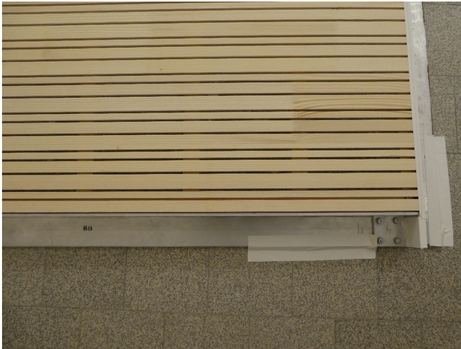
Abbildung 5: Innenaufbau von Prüfobjekt 1 mit integrierter Schafwolle
