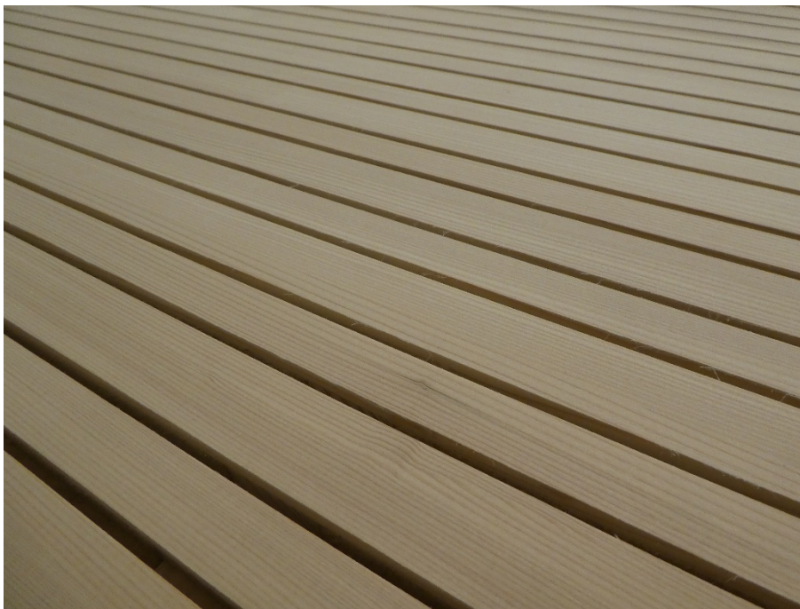
Abbildung 17: Oberfläche von Akustikpaneel Typ 2 mit 14.0% Schlitzanteil
