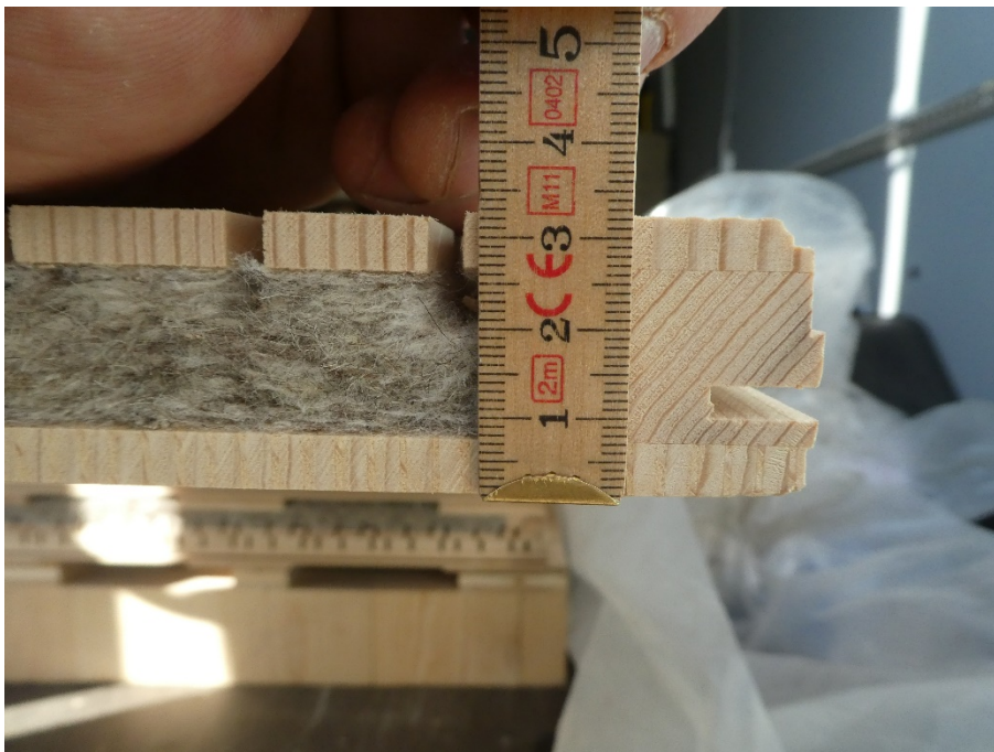
Abbildung 6: Innenaufbau von Prüfobjekt 1 mit integrierter Schafwolle
