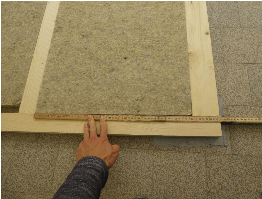
Abbildung 1: Abmessungen der Schafdämmwolle von Prüfobjekt 1
