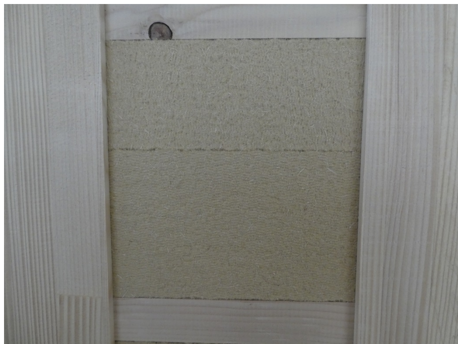
Abbildung 12: Innenaufbau von Prüfobjekt 3 mit integrierter Holzfaserplatte
